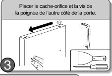
Serrer les vis desserrées plus haut, puis poser la vis de la
