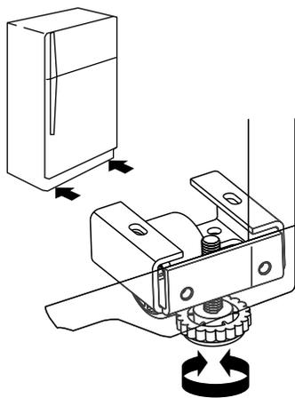
2. Ouvrir à nouveau les deux portes et vérifier que leur fermeture est aussi aisée que vous le souhaitez. Si ce n'est pas le cas, incliner le réfrigérateur un peu plus vers l'arrière en tournant les deux pieds de nivellement vers la gauche. Plusieurs tours seront peut-être nécessaires.
