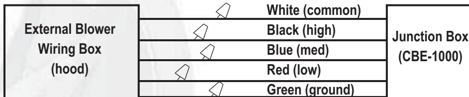
CBE-1000: WIRING DIAGRAM
