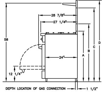
A - ISLAND TRIM HEIGHT - 38 1/4"B - 6" STANDARD BACKGUARD HEIGHT - 43 1/4"C - 17" BACKGUARD HEIGHT - 54 1/4"D - HIGH SHELF BACKGUARD HEIGHT - 61"
