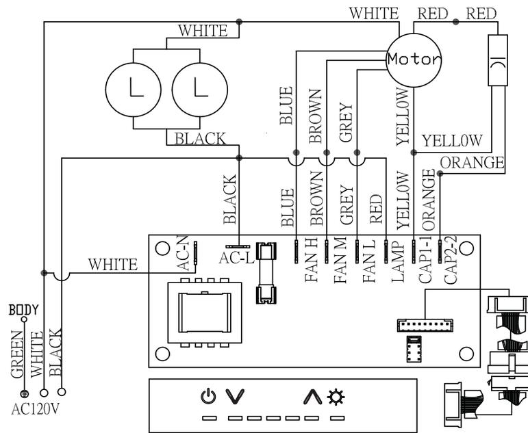
CONDENSER 11+11µF 250V AC FIT AC120V 60Hz
