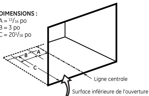
**C** Retirez le gabarit et percez les deux trous destinés au renfort du support antibasculement.
