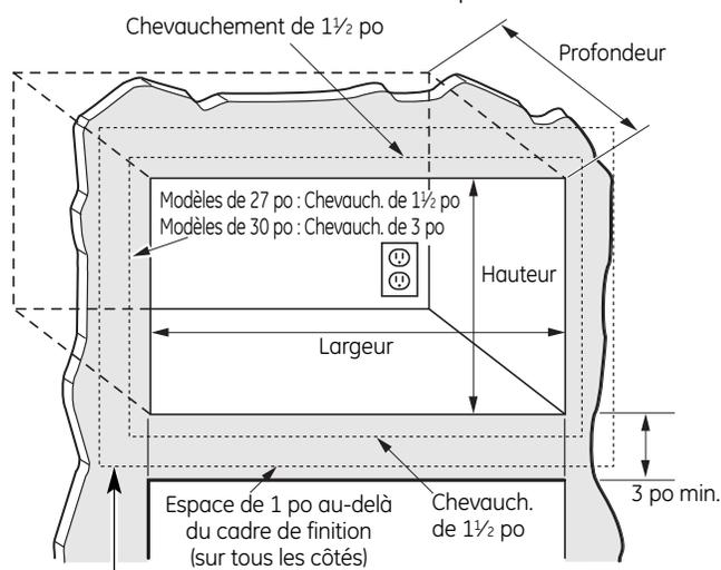
La partie inférieure du cadre de finition doit être à au moins 36 po du sol
