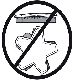
Positionnement incorrect de la cuvette du brûleur
