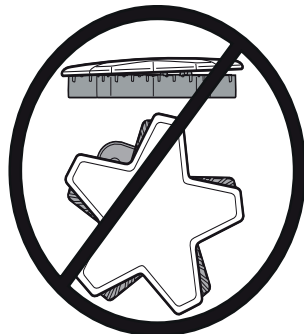
Incorrecto de la tapa del quemador
