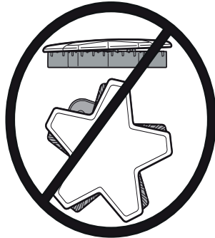
Positionnement incorrect de la cuvette du brûleur
