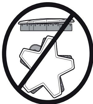
Incorrecto de la tapa del quemador
