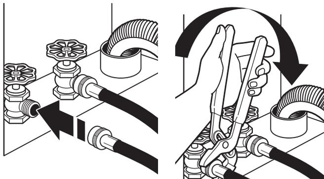
**REMARQUE :** Ne pas serrer excessivement ou utiliser du ruban adhésif ou un calfeutrant sur la valve. Les valves risquent d'être endommagées.
