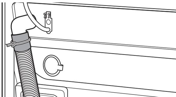
Le système de vidange de la laveuse peut être installé à l'aide d'un conduit d'évacuation au plancher, un tuyau de rejet à l'égout rigide au mur ou au plancher ou un évier de buanderie.
