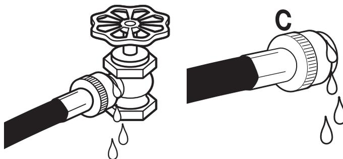
**REMARQUE :** Remplacer les tuyaux d'arrivée d'eau après 5 ans d'utilisation pour réduire le risque de défaillance. Prendre note de la date d'installation ou de remplacement des tuyaux, pour référence ultérieure.
