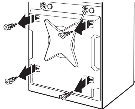
4. Une fois que les 4 boulons ont été retirés, jeter les boulons et les cales d'espacement. Puis pousser la fiche du cordon d'alimentation électrique à travers l'ouverture sur le côté droit du panneau arrière, tirer le cordon d'alimentation électrique à travers l'ouverture sur le côté gauche du panneau arrière et obturer les trous avec le bouchon fourni. Ne pas tirer l'extrémité du cordon d'alimentation à travers le trou de droit.
