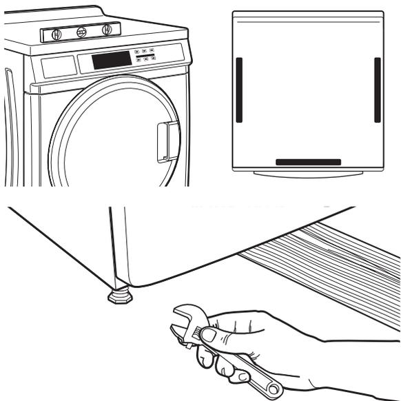
Si la laveuse est placée contre un mur, on doit l'écarter légèrement du mur avant de l'incliner vers l'arrière. Si la laveuse n'est pas d'aplomb, soulever l'avant de la laveuse avec une cale de bois et ajuster la position des pieds selon le besoin; soulever ensuite l'arrière de la laveuse et ajuster la longueur des pieds selon le besoin. Répéter ces opérations jusqu'à l'obtention d'un aplomb correct de la laveuse.
