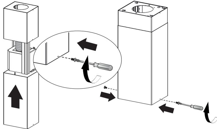
De la même façon, placez la section inférieure de la cheminée et fixez la partie inférieure au châssis à l'aide des 2 vis enlevées précédemment.
