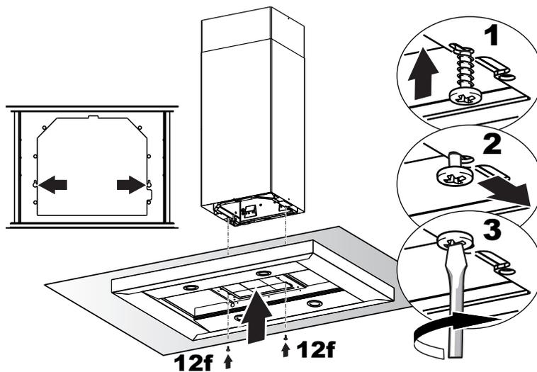
Vissez les 2 vis 12f à moitié dans les trous prévus sur les bords du dessous du châssis.
