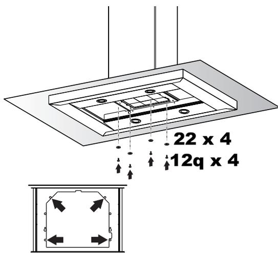
En passant par le dessous, fixez l'auvent de la hotte au châssis aux endroits indiqués, en utilisant les 4 vis 12q et les 4 rondelles 22 fournies, puis serrez fermement toutes les vis.
