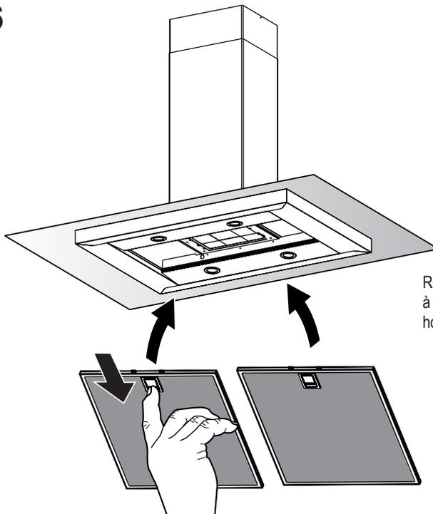
Remettez en place les filtres à graisse de l'auvent de la hotte.
