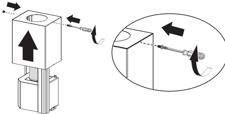
Placez la section supérieure de la cheminée et fixez la partie supérieure au châssis à l'aide des 2 vis enlevées précédemment.
