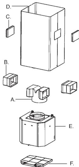
L'installation sans conduit nécessite une **Trousse de conversion pour installation sans conduit** dont les éléments sont représentés à la **FIGURE 12**.
