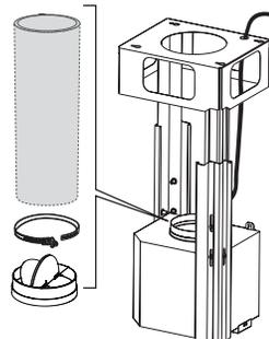
Installez le registre inclus avec la hotte avant de la raccorder aux conduits.
