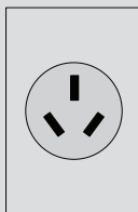
NEMA 10-50R Receptacle (solamente para US)
