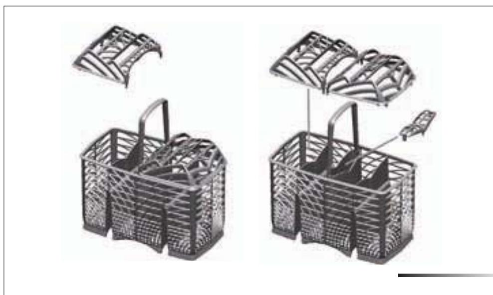
Le panier à couverts coulisse dans le sens transversal et peut être placé à n'importe quel endroit permettant une utilisation optimale de l'espace du panier inférieur.
