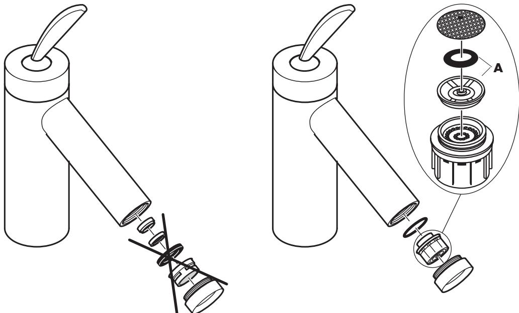
Bei Problemen mit dem Durchlauferhitzer oder wenn mehr Wasserdurchsatz gewünscht wird, kann der Waterdimmer® (Durchflussbegrenzer **A**), der hinter dem Luftsprudler sitzt entfernt werden.
