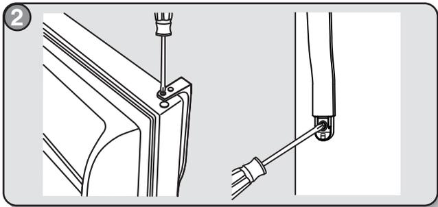
2 Aligner l'une des poignées avec les vis de la porte et pousser fermement la base contre la porte. Serrer partiellement les vis (2 tours).
