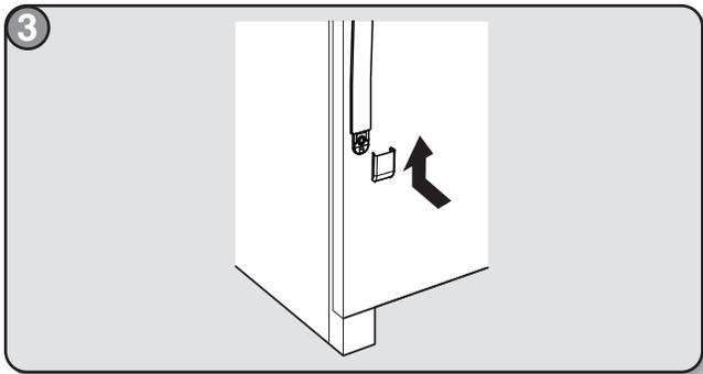
3 Serrer complètement les vis et serrer d'un quart de tour supplémentaire. Installer le couvre-vis.
