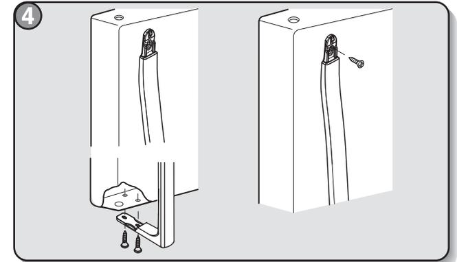
4 Aligner la deuxième poignée avec les vis de la porte et pousser fermement la base contre la porte. Serrer partiellement les vis (2 tours).
