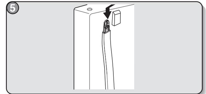
5 Serrer complètement les vis et serrer d'un quart de tour supplémentaire. Installer le couvre-vis.
