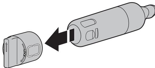
5. Installer le capuchon de filtre à eau sur le nouveau filtre. Aligner les flèches pour que les rainures du filtre s'enlignent avec les nervures du capuchon.
