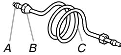
A. Manguito de compresión B. Tuerca de compresión C. Tubería de cobre
