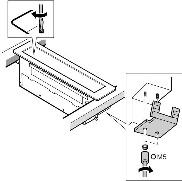
**3** Usar la ayuda de montaje. Introducir y alinear la ventilación de la tina en el hueco correspondiente. Quitar el elemento de cierre. Colocar la ayuda de montaje en diagonal en el hueco de ventilación y alinearla de forma vertical al equipo. Coloque el equipo en diagonal frente a la ventilación de la tina y presiónelo para introducirlo en el hueco con la ayuda de montaje. Retire la ayuda de montaje. Fijar la ventilación como se describió anteriormente.
