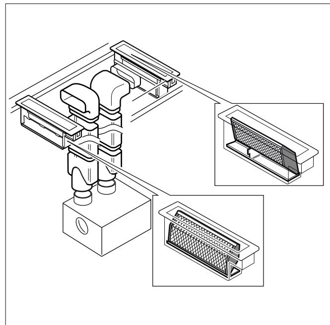
En cas de sortie d'air vers le bas, placer le filtre à graisse sans la plaque de positionnement dans l'élément de ventilation. L'horizontalité du filtre à graisse n'a pas d'importance.
