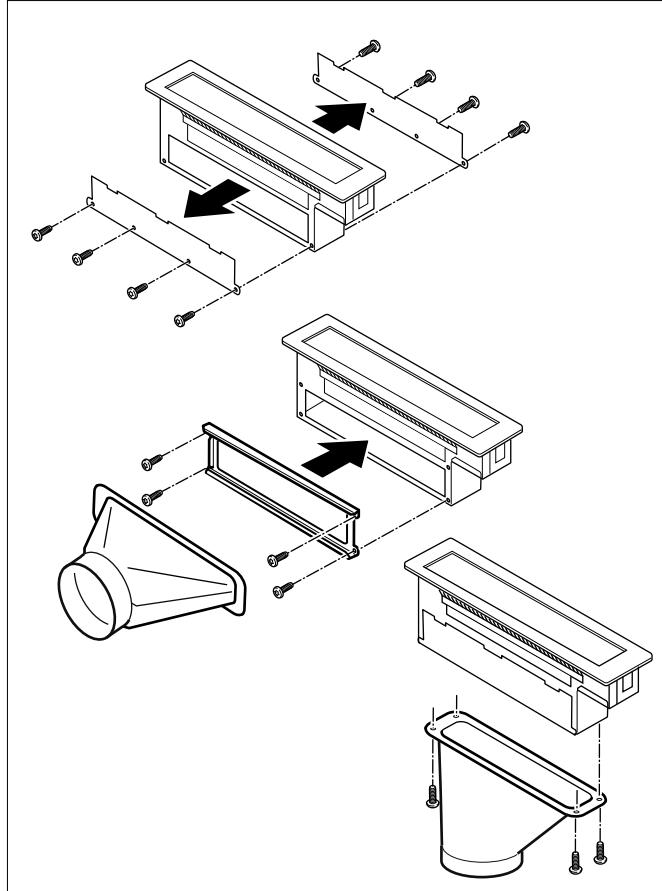
**5** Fixer le tuyau d'évacuation à la tubulure et étanchéifier de manière appropriée.
