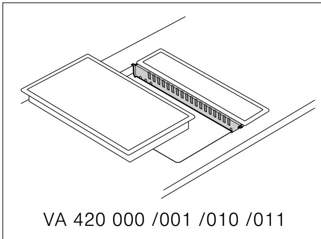
Los equipos se pueden instalar también en huecos individuales , manteniendo una distancia mínima de separación entre los equipo de 2" (51 mm).
