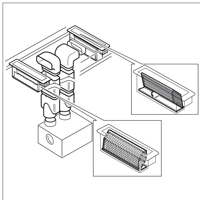
Si la salida de aire está orientada hacia abajo, colocar el filtro antigrasa en el elemento de ventilación sin utilizar la placa de posicionamiento. La orientación del filtro antigrasa es irrelevante.
