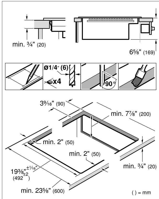
**Pose en affleurement:** L'appareil peut être posé en affleurement dans un plan de travail.
