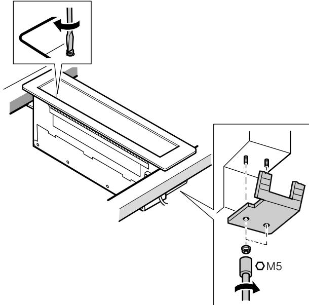
**3** Utiliser l'aide au montage. Insérer horizontalement l'aérateur dans la découpe et ajuster. Enlever l'élément obturateur. Insérer l'aide au montage en position oblique dans la découpe et l'ajuster perpendiculairement à l'appareil. Présenter l'appareil incliné devant l'aérateur de table et le pousser dans la découpe au moyen de l'aide au montage. Retirer l'aide au montage. Fixer l'aérateur de table de cuisson conformément à la description ci-dessus.
