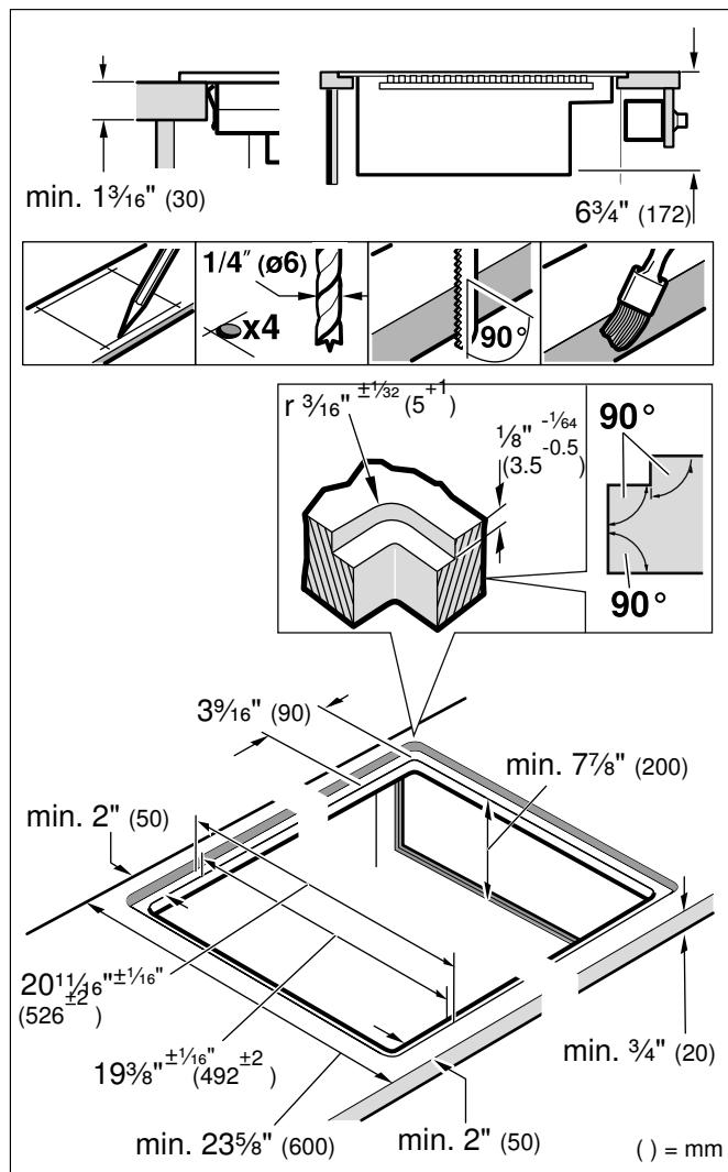
**Pose en affleurement:** L'appareil peut être encastré dans des plans de travail résistant à la chaleur et à l'eau, fabriqués dans les matériaux suivants :
