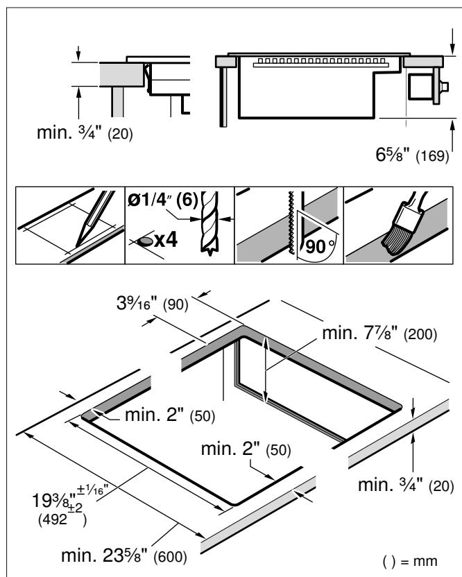
**Montaje a ras de superficie:** se puede realizar un montaje a ras de superficie de la encimera.
