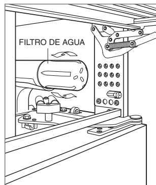
Extracción del filtro de agua.
