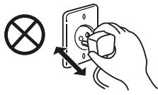
No dañe ni utilice un cable de alimentación no especificado.
