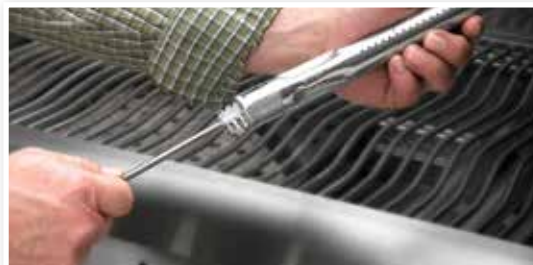
62005 Venturi Cleaner Limpiador Venturi Attrezzo pulizia tubi Venturi Шомпол для чистки трубки Вентури
