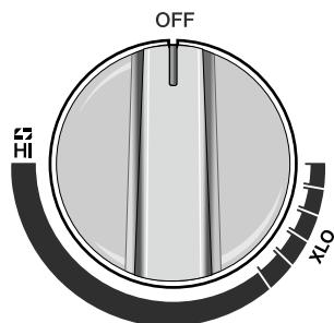
Pour actionner : Sélectionner le bouton de commande appropriée, l'enfoncer et le tourner en sens antihoraire jusqu'à un des cinq réglages XLO. Fermer le brûleur en tournant le bouton de commande en sens horaire à **OFF** (ARRÊT).
