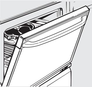
Deje la puerta abierta en la posición de detención de asado. La puerta queda abierta, y aún así se mantiene la temperatura adecuada en el horno.
