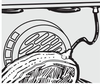
La sonda de temperatura cuenta con una sonda similar a un pincho en un extremo y un enchufe en el otro extremo que se introduce en la boca de salida del horno.
