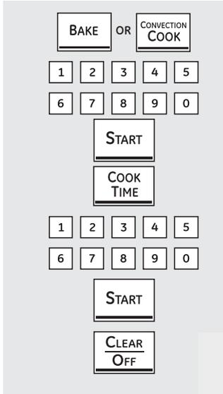
El horno se enciende inmediatamente y cocina los alimentos durante un período de tiempo seleccionado. Al finalizar el tiempo de cocción, el horno se apaga automáticamente.
