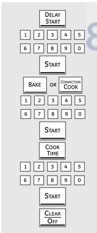
El horno se encenderá en el horario que usted haya configurado, cocinará alimentos durante un período de tiempo específico y luego se apagará automáticamente.
