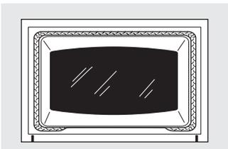
La junta está diseñada con un espacio en la parte inferior para permitir una adecuada circulación de aire.
