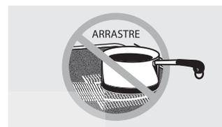
No deslice los recipientes de cocción a través del control y la superficie de la estufa porque puede rayar el vidrio. El vidrio es resistente a los rayones, pero no a prueba de los mismos.
