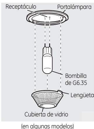
**Reemplazo de la bombilla del horno** (en algunos modelos)**Para retirar:**
