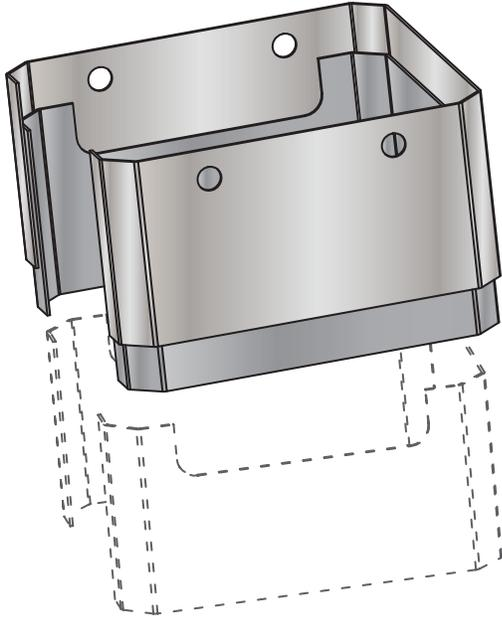
5. Fije el ensamblaje de las cubiertas a través de los agujeros hundidos con dos tornillos Torx de acero inoxidable de ½ pulg. (incluidos), como se muestra aquí abajo.
