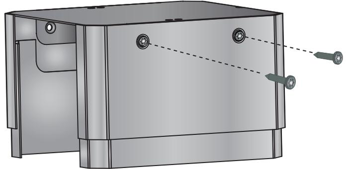
3. Debajo de la estufa, instale las piezas ensambladas alrededor de una pata.
