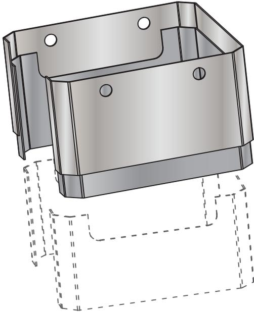
5. Fixez l'assemblage des pièces de recouvrement à travers les trous en fossette à l'aide de deux (2) vis Torx en acier inoxydable de ½ po (incluses), comme illustré ci-dessous.
