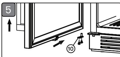
5. Installez l'axe inférieur de la porte (10) et installez la porte une fois correctement alignée.
