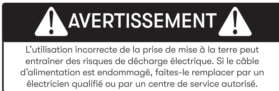
Pour assurer votre sécurité, cet appareil doit être dûment mis à la terre. Pour minimiser les risques de décharge électrique, le câble d'alimentation de cet appareil est muni d'une fiche à trois broches qui s'adapte aux prises murales standards à trois bornes.
