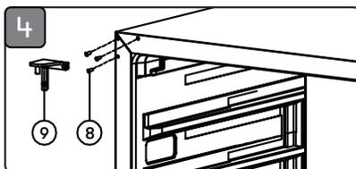
4. Retirez les clous décoratifs gris (8) du haut à gauche de l'armoire. Installez les clous décoratifs gris en haut à droite de l'armoire et installez la nouvelle charnière supérieure (9) de l'ensemble de quincaillerie qui comprend le manuel d'installation en haut à gauche de l'armoire avec 3 vis.
