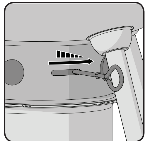
Zavřít větrací otvory
