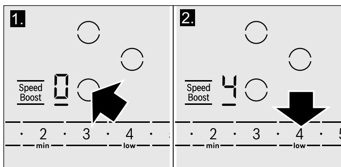
3. Para cambiar el nivel de potencia, seleccione el elemento y programe el nivel de potencia deseado con las teclas numéricas. Para programar un nivel intermedio, pulse los símbolos **•** que se encuentran entre las teclas numéricas.
