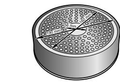
Pour obtenir de bons résultats de cuisson, nous vous recommandons de faire correspondre le diamètre de la surface ferromagnétique de l'ustensile de cuisson avec la taille du foyer. Si une casserole ou une poêle n'est pas reconnue sur son foyer, tentez de la placer sur un foyer de diamètre inférieur.
