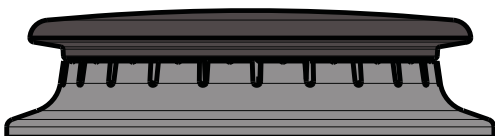
Placement correct d'un capuchon de brûleur
