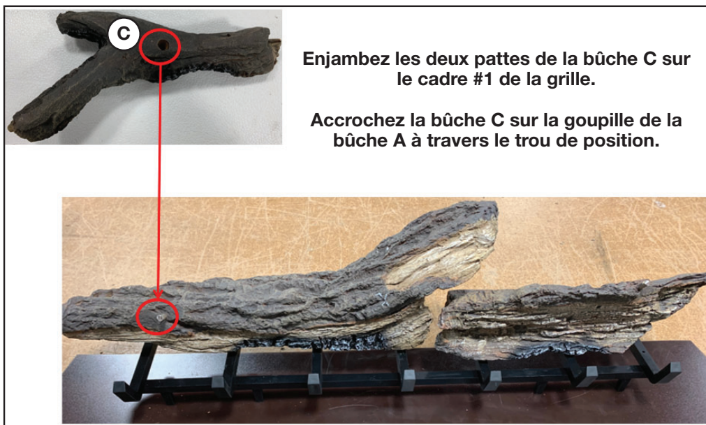
BÛCHE C : VUE DÉTAILLÉE DE L'INSTALLATION
