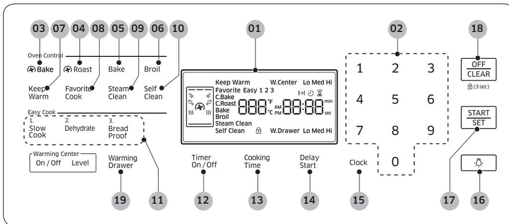
**01 ÉCRAN :** indique l'heure, la température du four, si le four est en mode Cuisson, Gril ou Auto-nettoyage et le temps réglé pour la minuterie ou le fonctionnement automatique.
