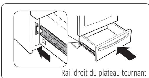
1. Placez les extrémités des rails du plateau tournant à extension complète dans les rails latéraux de l'ouverture du tiroir.
