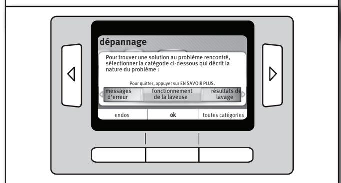
Utiliser ensuite les boutons de commande ACL pour sélectionner le thème de dépannage souhaité. On peut utiliser les boutons ◀ et ▶ pour naviguer entre les différentes options.
