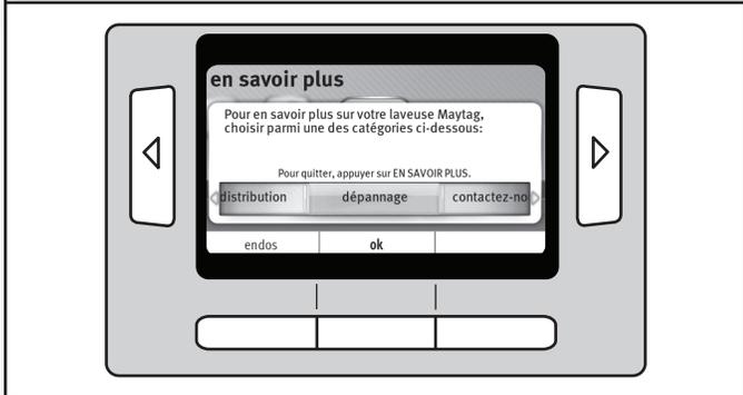
Alors que la laveuse est allumée, appuyer sur LEARN MORE pour accéder à la caractéristique de DÉPANNAGE intégrée. Utiliser les boutons de commande ACL pour sélectionner DÉPANNAGE.
