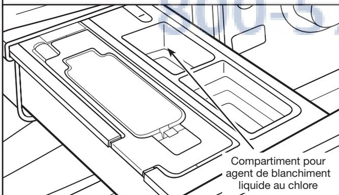
Ajouter une mesure d'agent de blanchiment liquide au chlore dans le compartiment d'agent de blanchiment. Ne pas remplir excessivement le distributeur, diluer le produit ou utiliser plus de 2/3 de tasse (165 mL). Ne pas utiliser d'agent de blanchiment sans danger pour les couleurs ni de produit Oxi avec un programme utilisant de l'agent de blanchiment au chlore liquide.
