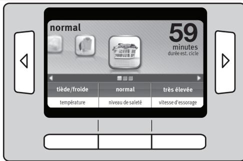
L'affichage indique les réglages par défaut correspondant au programme sélectionné. Si désiré, appuyer sur le bouton situé sous chaque réglage pour ajuster la température, le niveau de saleté, la vitesse d'essorage et ajouter des options telles qu'un rinçage supplémentaire. Utiliser les touches en forme de flèches ◀ et ▶ pour rechercher les options supplémentaires.
