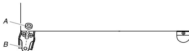
A. Rondelle d'étanchéité de la charnière inférieure B. Charnière inférieure
