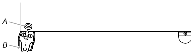
A. Arandela de la bisagra inferior B. Bisagra inferior
