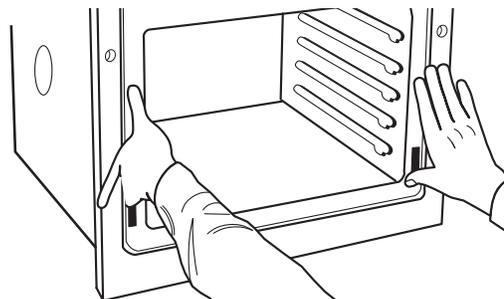
2. Fixer solidement le four à l'armoire à l'aide des vis fournies. Insérer les vis autotaraudeuses dans les trous situés sur le couvercle de la garniture latérale. Ne pas serrer excessivement les vis.
