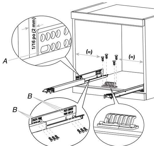
A. Avant de la platine de montage à 1/16 po (2 mm) de l'extérieur du cadre de l'armoire.
