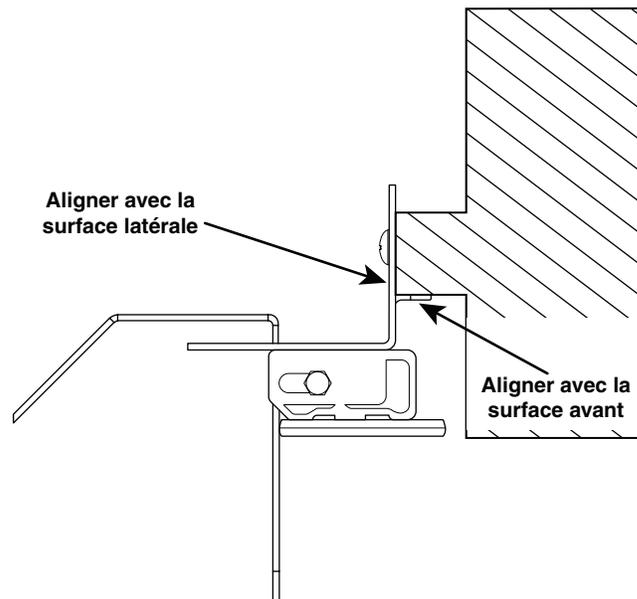
4. Modifier la position horizontale de l'ensemble structure/surface de garniture pour qu'il touche les surfaces latérales du gabarit de montage. Serrer les vis à tête hexagonale du haut de chaque ensemble.
