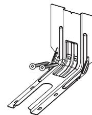
5. À l'aide des deux vis cruciformes no 10 x 1 5/8 po (4,1 cm) incluses, fixer la bride antibasculement au mur ou au plancher.
