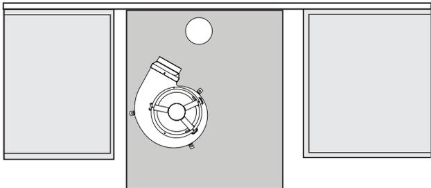
7. Connecter le système de ventilation résidentiel à l'adaptateur de prise pour ventilateur à l'aide d'une bride de fixation; recouvrir ensuite la connexion à l'aide de ruban aluminium.
