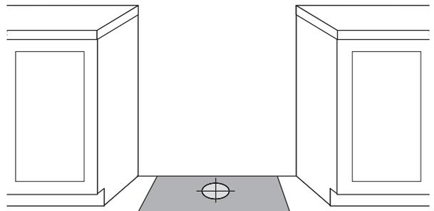
2. Tracer et percer le trou d'évacuation au niveau du plancher.
