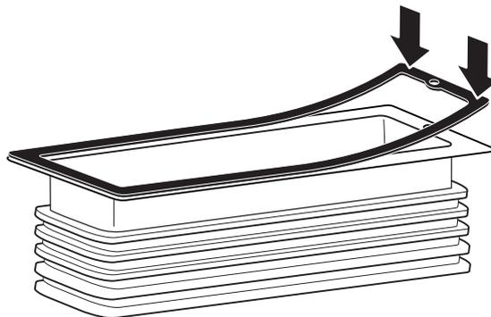
6. Poser le couvercle sur le ventilateur. Écartier légèrement le ressort de retenue du couvercle afin de permettre à ce dernier de se positionner sur le ventilateur.
