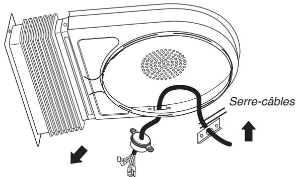
3. Passer le câble du moteur de ventilateur dans l'ouverture et placer la bride du serre-câbles à l'intérieur du couvercle du ventilateur. Mettre en place et serrer les deux (2) vis no 8-18 x 3/8 po comprises pour fixer la bride du serre-câbles.
