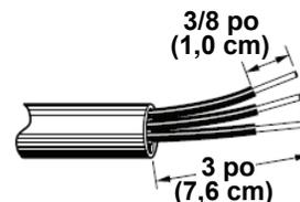
2. Laisser suffisamment de jeu pour raccorder facilement les conducteurs au bornier.
