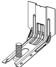
14. Tourner le couvercle du ventilateur pour que les soufflets soient bien en position. S'assurer que l'arrière de la bride du soufflet est bien engagé dans les supports de fixation.
