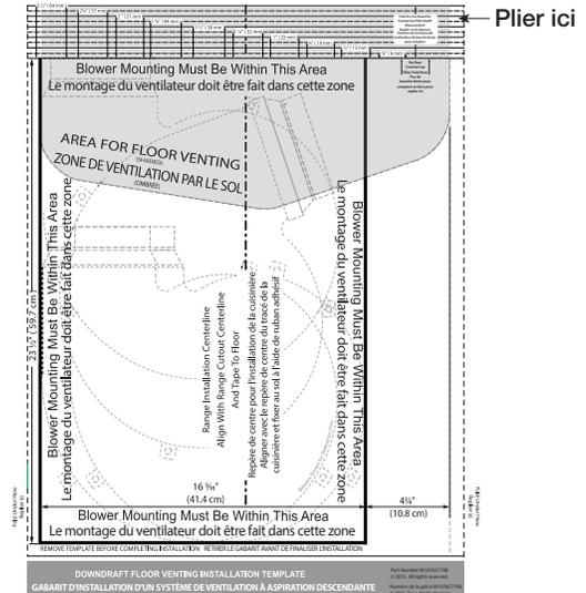
**REMARQUE :** Le gabarit comporte des lignes tous les 1/4 po (6,4 mm) du rebord arrière. Si la distance mesurée à l'étape précédente est de 1 1/4 po (32 mm), replier le gabarit sur la ligne étiquetée 1 1/4 po (32 mm). S'il n'y a pas de mortier pour comptoir, replier le gabarit sur le repère zéro (0).
