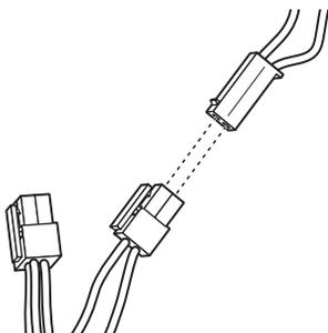
7. Repérer le connecteur à 4 broches du fil du ventilateur et la brancher au point de raccordement se trouvant directement à l'arrière du plateau de rangement du condensateur.
