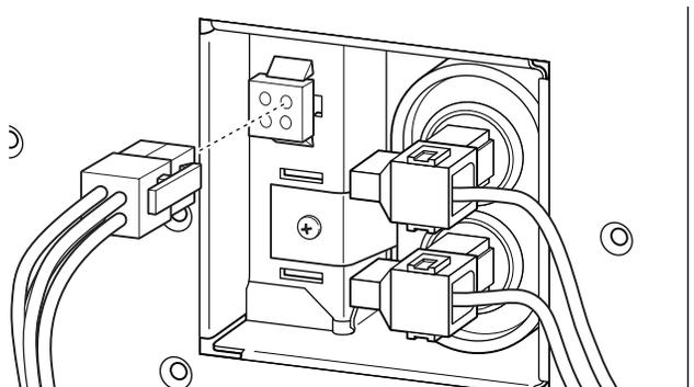
8. Replacer le cache-borne électrique du ventilateur.
