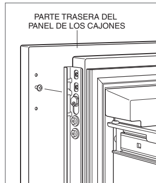
Montaje del panel del cajón.
