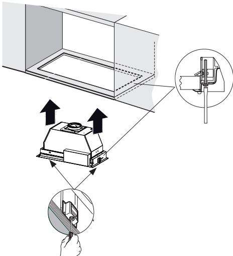
Instale la campana de inserción a través del recorte del armario en la abertura del armario que tiene una altura mínima de 16". Tenga en cuenta los conductos.
