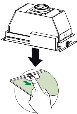
Retirez les trois filtres de la hotte encastrable avant de l'installer dans l'armoire.
