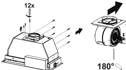
Para una instalación de conductos horizontales, el motor necesita ser desbloqueado retirando primero los 12 tornillos como se muestra.
