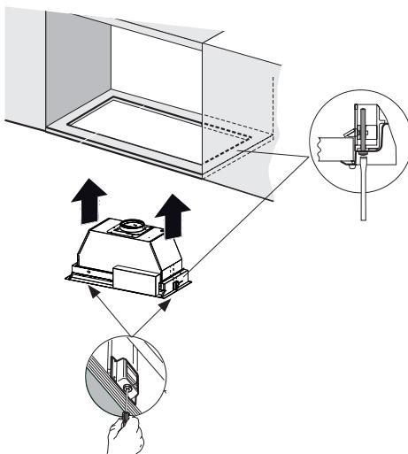
Insérez la hotte encastrable à l'intérieur de l'armoire par l'ouverture de l'armoire. Sa hauteur minimale doit être de 16". Prévoyez la canalisation.
