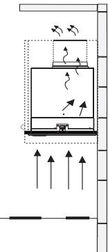
Para la ventilación de recirculación sin conducto, dirija la tubería a una ubicación por encima de la campana donde la descarga se ventila de regreso a la sala.
