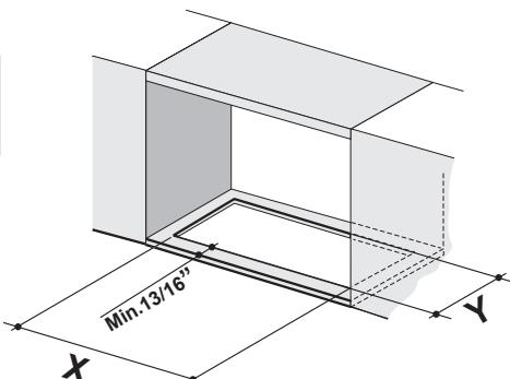
Recorte la abertura en la parte inferior del gabinete como se muestra en la Figura 1.
