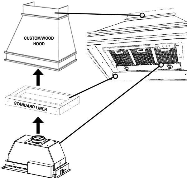
1. La campana de madera/personalizada debe tener una base resistente (se recomienda madera contrachapada de 3/4") para alojar el recorte para Inca HC . La base debe estar rebajada para alojar la altura del forro (consulte **DIMENSIONES DEL FORRO** en la Página 47). El forro se acopla a la parte inferior de la base con tornillos adecuados para el tamaño y el material de la campana de madera/personalizada. El Inca HC se inserta en el recorte en el forro y la base.
