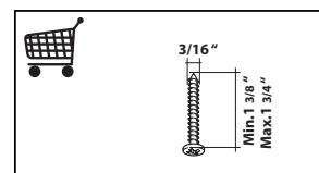
"Nota: Posibles puntos de fijación adicionales del producto con 4 tornillos"
