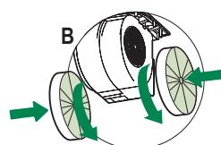
**Attention:** "Cuando se utiliza en modo de recirculación, para reducir el riesgo de incendio y descarga, use solo el kit de conversión Modelo FILTER 1 O FILTER1LL
