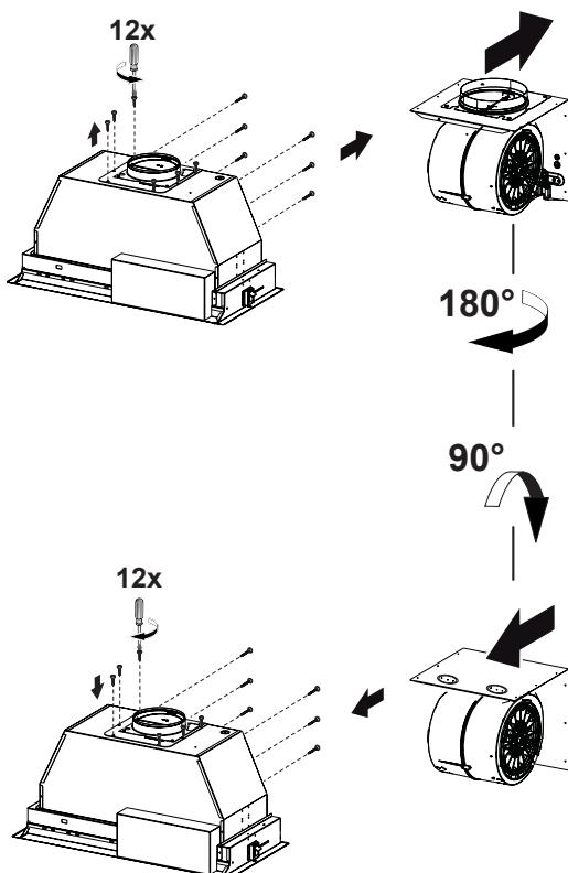
Pour l'installation d'une canalisation horizontale, le moteur doit d'abord être détaché. Pour ce faire, retirez les 12 vis comme illustré.
