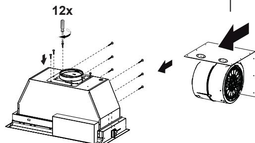
Una vez que el ventilador esté en su lugar, vuelva a instalar los 12 tornillos para sujetar el motor a la campana de inserción.
