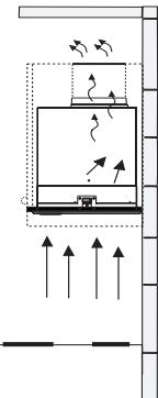
Pour la ventilation avec recirculation sans canalisation, dirigez les conduits à un emplacement au-dessus de la hotte où l'air évacué est retourné dans la pièce.
