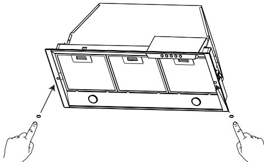
Inserte las 2 tapas en los orificios de los tornillos como se muestra.
