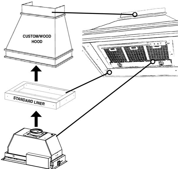
1. L'habillage de hotte sur mesure/en bois doit présenter une base solide (contre-plaqué de 3/4" recommandé) pour permettre l'ouverture pour la hotte Inca HC. La base doit être amincie pour accueillir la hauteur de la caisse (consultez **DIMENSIONS DE LA CAISSE** à la page 30). La caisse se fixe au bas de la base à l'aide de vis adaptées à la dimension et au matériau de votre habillage de hotte sur mesure/en bois. La hotte Inca HC s'insère dans l'ouverture de la caisse et de la base.
