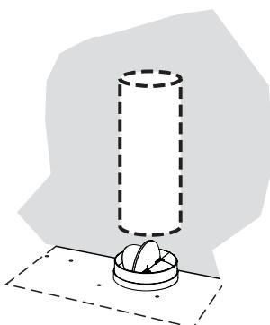
Instale el techo o la tapa de pared comprados por separado. Conecte los conductos metálicos de 6" al techo o a la tapa de pared y luego conecte los conductos.
