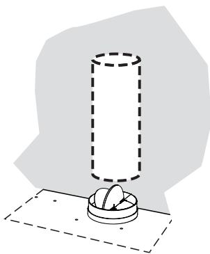
Installez le clapet de toiture ou le clapet mural acheté séparément. Raccordez le conduit métallique de 6" au clapet de toiture ou au clapet mural, puis raccordez les conduits.
