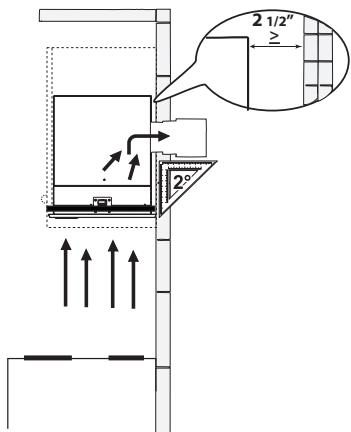
Pour l'installation d'une canalisation horizontale (à l'arrière), un espace d'au moins 2 1/2" est requis entre l'arrière de la hotte encastrable et le mur.
