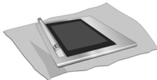
6. Placer la porte sur une surface facilement accessible et stable jusqu'à ce que vous soyez prêt(e) à la remettre en place. Poser la porte sur une serviette ou une section de rembourrage de protection en mousse pour éviter d'endommager la porte ou le sol.
