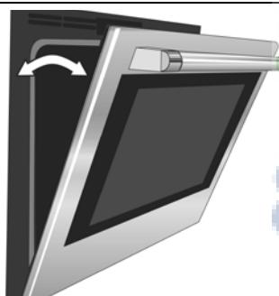
4. En maintenant fermement la porte des deux côtés avec les deux mains, fermez délicatement la porte jusqu'à ce qu'elle vienne buter contre les leviers, à environ 30° de la position de fermeture.
