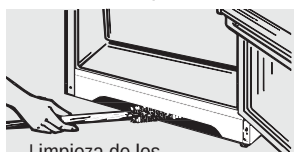
Limpieza de los serpentines del condensador
