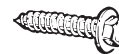
⑤ Vis à tête hexagonale pour collier de serrage de conduite d'eau (3/4 po)*
