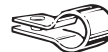
6 Abrazadera para la tubería del agua (alivio de presión), para la tubería del agua de la casa
