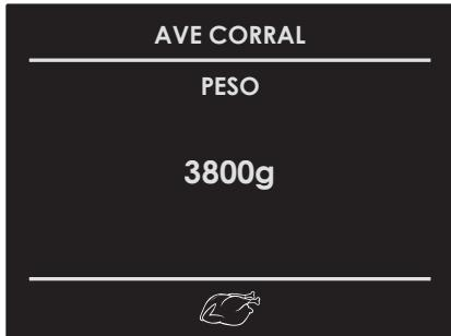
3. El horno cambia automáticamente al tiempo de cocción. Para cambiar este tiempo, utilice el botón de [FUNCIÓN] para ajustar el tiempo de cocción y confirme presionando el mismo botón.
