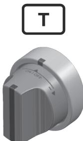
PRESIONAR ON/OFF: Enciende y apaga el horno.
