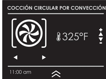
3. El display muestra el ícono de la función activa hasta que se haya alcanzado la temperatura configurada. Después de ello la función comuta en automático el modo de cocción pre seleccionado.
