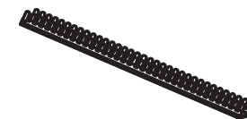
Protecteur de rebord (1) (Si le trou des raccords se trouve dans une cloison métallique, vous devez apposer le protecteur de rebord fourni pour éviter d'endommager le cordon d'alimentation ou les tuyaux.)
