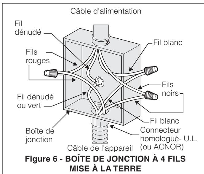
**⚠ ATTENTION** Si la connexion a été faite en utilisant un système électrique à 4 fils, le châssis de l'appareil **NE DOIT PAS** être branché au fil neutre du câble à 4 fils.
