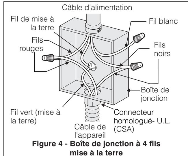
**⚠ ATTENTION** Si la connexion a été faite en utilisant un système électrique à 4 fils, le châssis de l'appareil NE DOIT PAS être branché au fil neutre du câble à 4 fils.
