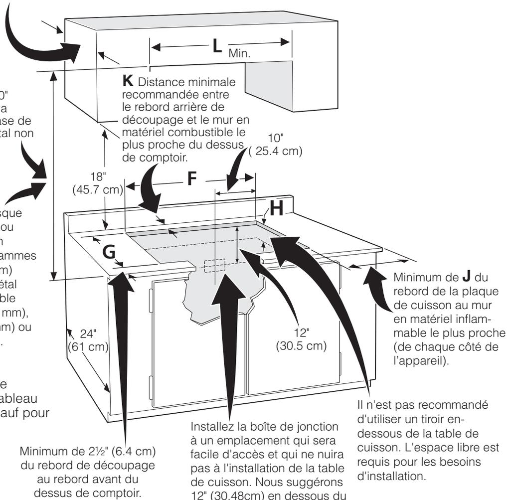
**⚠ AVERTISSEMENT** Pour éliminer les risques de brûlures ou de feu en allongeant le bras au-dessus des surfaces de cuisson chaudes, évitez d'installer des armoires au-dessus de la plaque de cuisson. Si vous devez en installer, il est possible de réduire le risque en plaçant une hotte pour cuisinière qui excède horizontalement d'un minimum de 5" (12.7 cm) la base de l'armoire.
