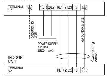
Figure 52: Terminal Block Wiring Diagram LS180HEV1, LS240HEV1 LS180HEV1, LS240HEV1
