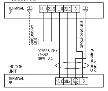
Figure 51: Terminal Block Wiring Diagram LS120HEV1
