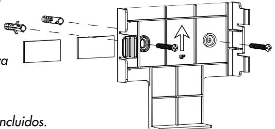
**Recommandation :** Suivez les mesures proposées ci-dessous pour déterminer le meilleur emplacement pour le support. Placez le support afin qu'il n'y ait pas plus de 6 po entre le côté gauche du support et le robinet. Laissez une distance d'au moins 2 po entre le côté
