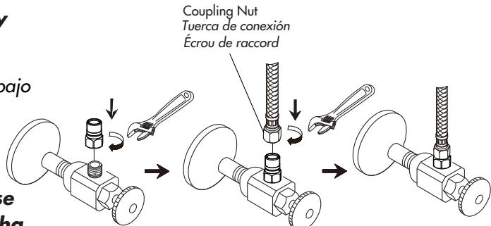
*Installez les vannes de contrôle de filtre à l'approvisionnement en eau sous l'évier, et serrez le tuyau sur les clapets. Clapets de filtre aident les débris du filtre dans l'eau. Le flexible gris/rouge est pour l'eau chaude et le flexible gris/bleu est pour l'eau froide.*
