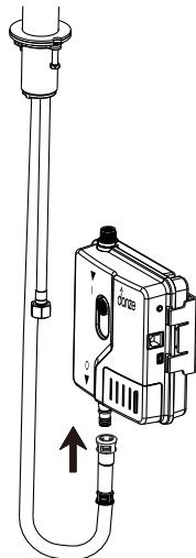
*Instale el conjunto de la manguera de conexión rápida, para instalar los empalmes rápidos, siga estas indicaciones:*
