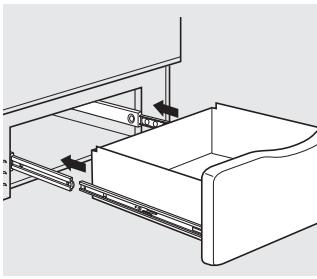
La mayor parte de la limpieza se puede realizar con el cajón en su lugar. Sin embargo, el cajón puede ser retirado si es necesario continuar con la limpieza. Use agua caliente y jabón para limpiar a fondo.
