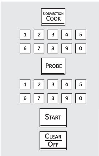
Para cambiar la temperatura del horno durante el ciclo de rostizado por convección, presione el botón CONVECTION COOK (cocción por convección) y luego presione las almohadillas numéricas para configurar la nueva temperatura deseada.
