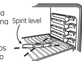
C A fin de colocar la cocina en su posición, las patas niveladoras traseras deberán ser ajustadas. Se podrán ajustar desde la parte trasera en la parte inferior de la cocina.
