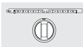
La mayoría de las comidas a la plancha requieren una cocción en una superficie precalentada. Precaliente la plancha de acuerdo con la siguiente guía, y luego cambie a la configuración de cocción deseada.
