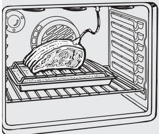
La sonda de temperatura cuenta con una sonda similar a un pincho en un extremo y un enchufe en el otro extremo que se introduce en la boca de salida del horno.
