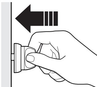
Presione hacia adentro y gire la perilla del cajón del horno inferior hacia cualquier configuración deseada.
