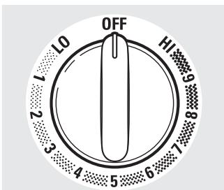
En OFF (apagado) y HI (alta) el control se traba en su posición con un "clic". Usted puede oír ligeros chasquidos durante la cocción, que indican que el control está manteniendo su configuración deseada.
