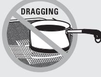
No deslice el utensilio sobre la superficie de la cocina o del control, ya que se podrá rayar el vidrio. El vidrio es resistente a rayones; no es a prueba de rayones.
