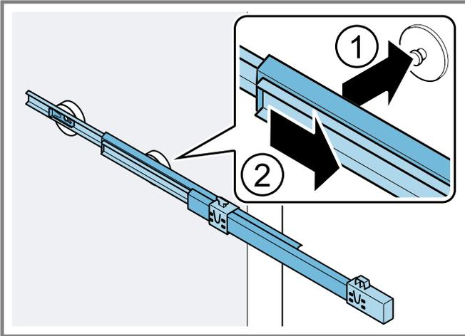
2. Montar el raíl telescópico en el perno posterior ① y desplazar el bloqueo hacia atrás ②.
