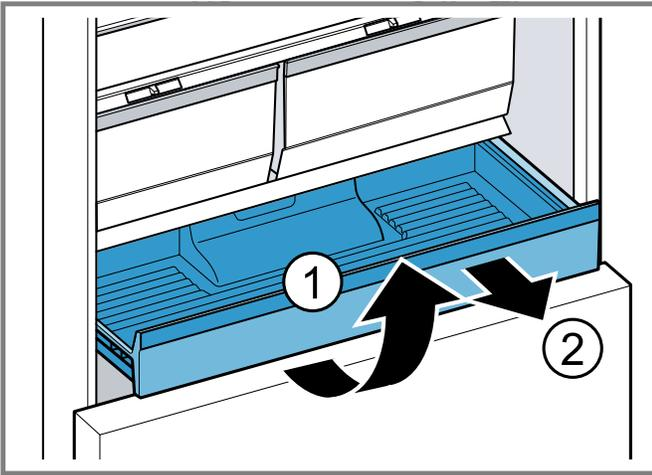
2. Levantar el cajón deslizante de productos congelados por delante y retirarlo.
