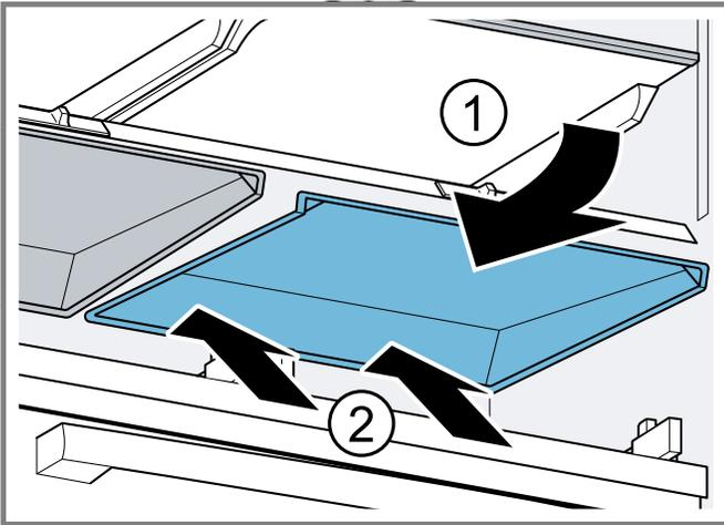
2. Enganchar uno de los lados delanteros de la tapa del cajón para frutas y verduras ①, doblar ligeramente hacia abajo por la parte central ② y enganchar el otro lado delantero ③.
