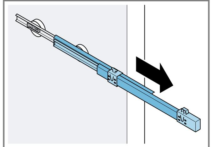
2. Poussez le dispositif de verrouillage dans le sens de la flèche ① et relâchez-le par le boulon arrière ②.
