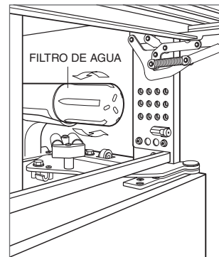
Extracción del filtro de agua.
