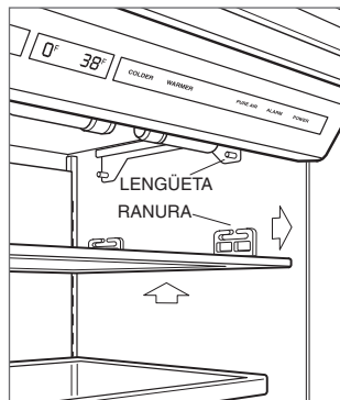
Instalación del difusor de luz.
