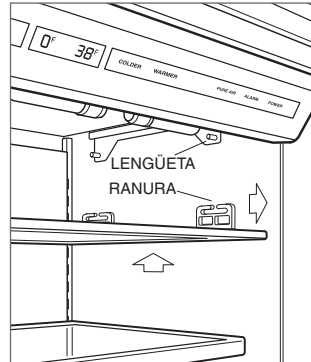
Instalación del difusor de luz
