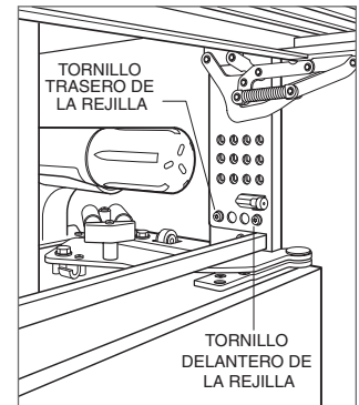
Tornillos de montaje de la rejilla.
