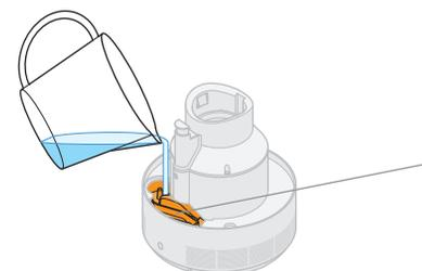
Vacíe el agua de la cubeta ya que pueden producirse pequeños derrames. Si bien no es peligroso, debe tener precaución a fin de evitar que ingrese agua en las entradas. Limpie minuciosamente usando la solución de ácido cítrico recomendada. No lo enjuague debajo del grifo de agua ni lo
