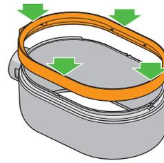
Para fijar el anillo que rodea el bucle amplificador, colóquelo en posición horizontal y alinee el anillo con el amplificador principal. Presione firmemente hasta que escuche un clic y se acomode en su posición, tal como se muestra en la imagen.
