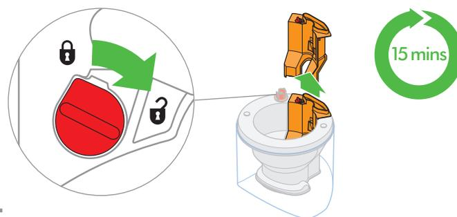
Vacíe el tanque de agua. Para liberar la chimenea para agua, gire el disco un cuarto de vuelta. Levántela y retírela. Límpiela minuciosamente sumergiéndola en la solución de ácido cítrico durante 15 minutos. Enjuague y seque todas las superficies. Repita de ser necesario. Reinstale las piezas siguiendo el orden inverso y gire el disco un cuarto de vuelta hasta que quede ajustado.
