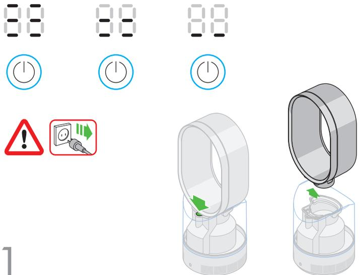
1 Desconecte el equipo y presione el botón para desbloquearlo. Levante el bucle amplificador y sáquelo del tanque, y luego retire el tanque de la base.
