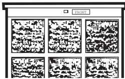
Filtre encrassé – Requiert un nettoyage
